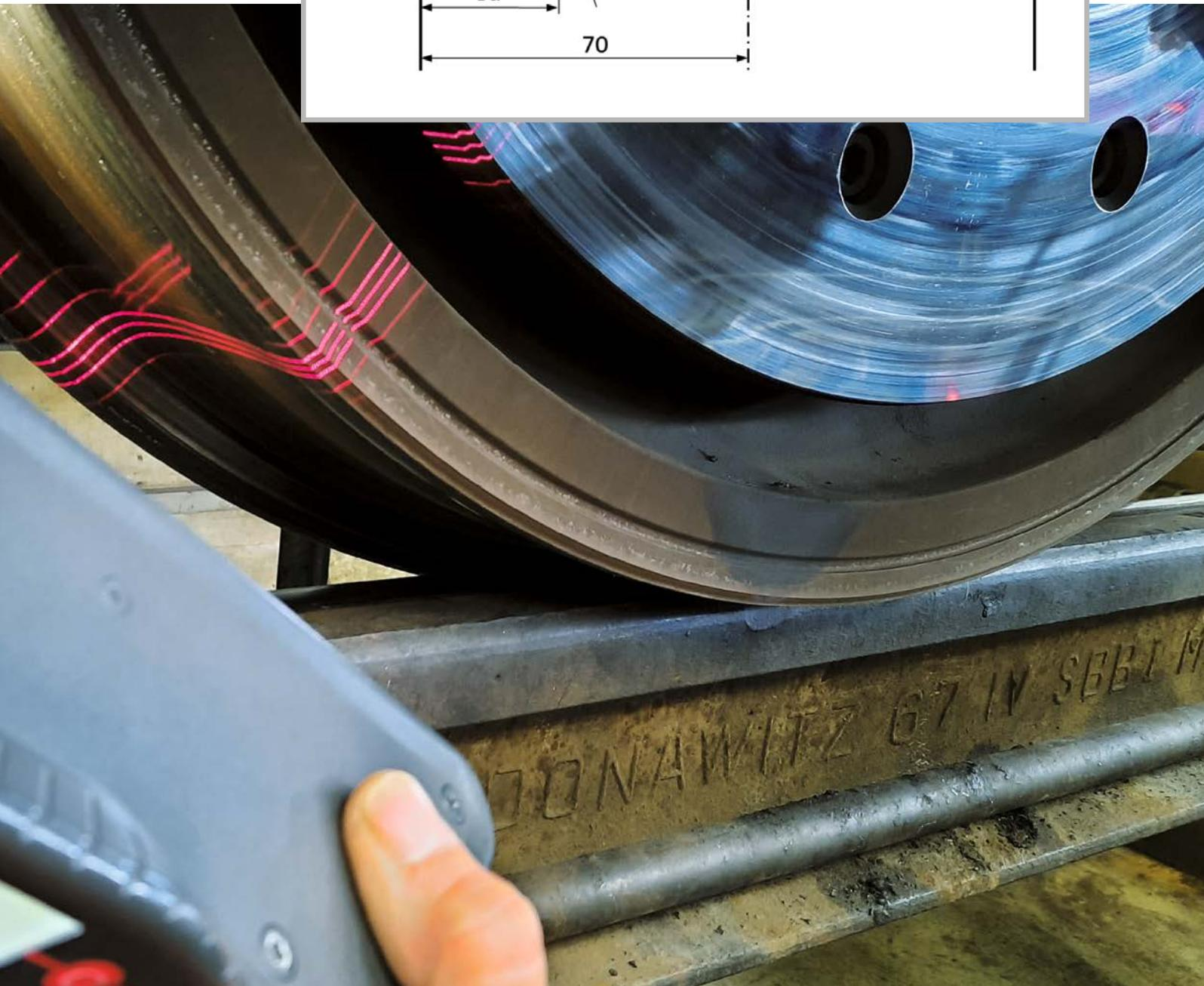
Längs der Schiene montierte Laser machen das Radprofil erkennbar; fremde Teile in Radnähe dürfen das automatische Ermitteln der Nutzgrößen nicht beeinträchtigen.
