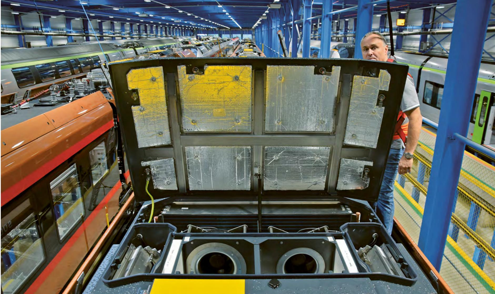
Auf dem Dach des Traverso in Erlen: Jakob Bühler prüft die Befestigung der Erdlitzen und die Kabelführungen, öffnet alle Deckel (etwa diejenigen der Klimaanlage oder der Brandschutzanlage) und prüft, ob sie sich gut schliessen lassen.
