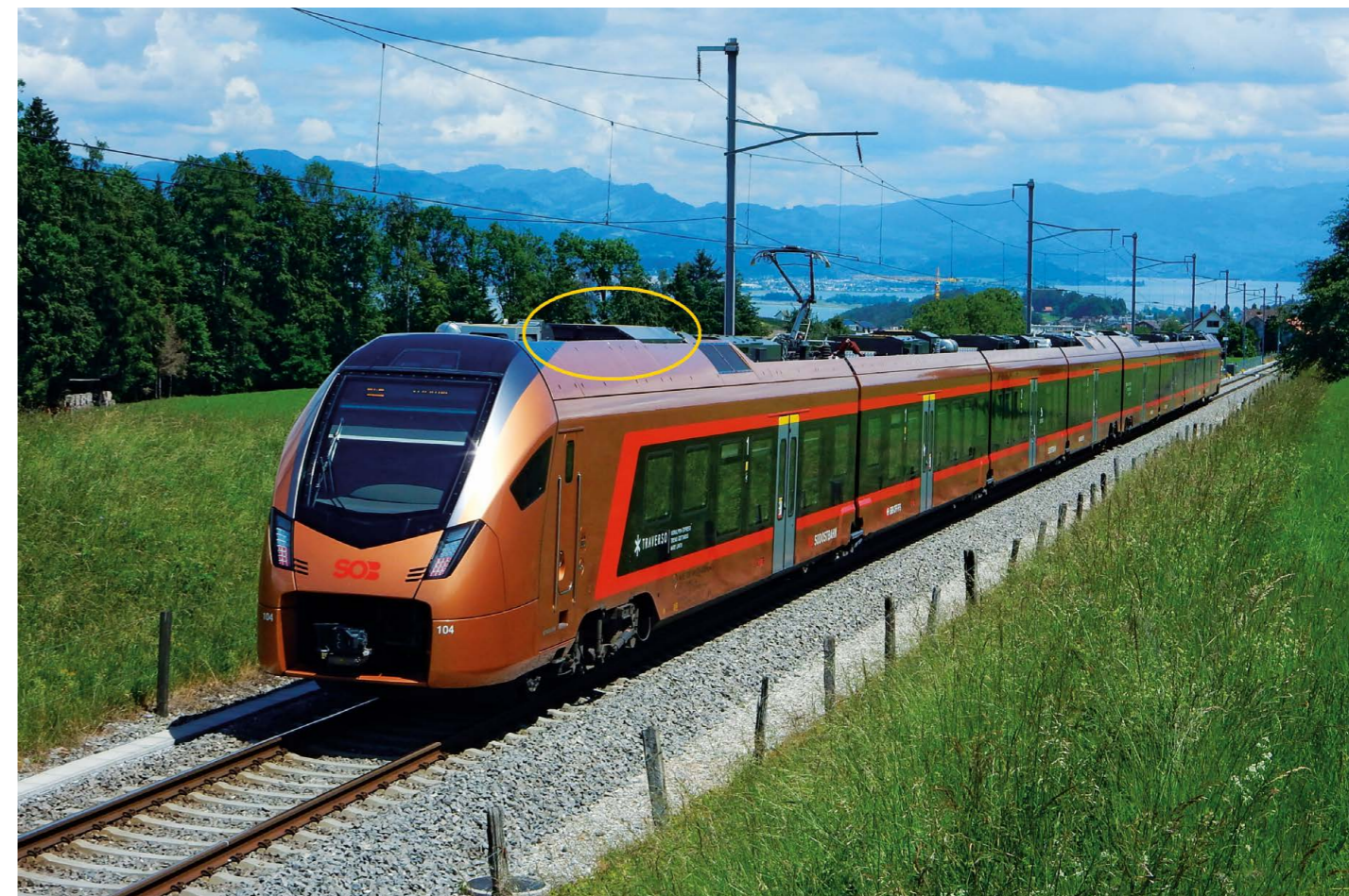
Der Traverso besitzt vier Trockentransformatoren.
