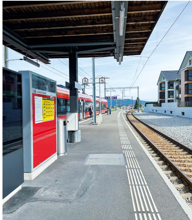
Die taktil-visuellen Sicherheitslinien zeigen an, in welchem Bereich des Perrons das Warten sicher ist.
