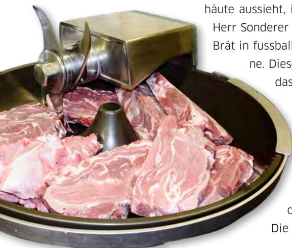
Der Cutter zerkleinert das Fleisch, bis eine feine Masse entsteht: das Brät.
